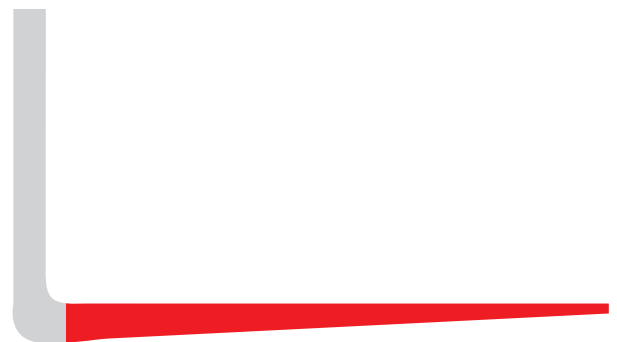
Abschrägung auf voller Länge unten + optional poliert
